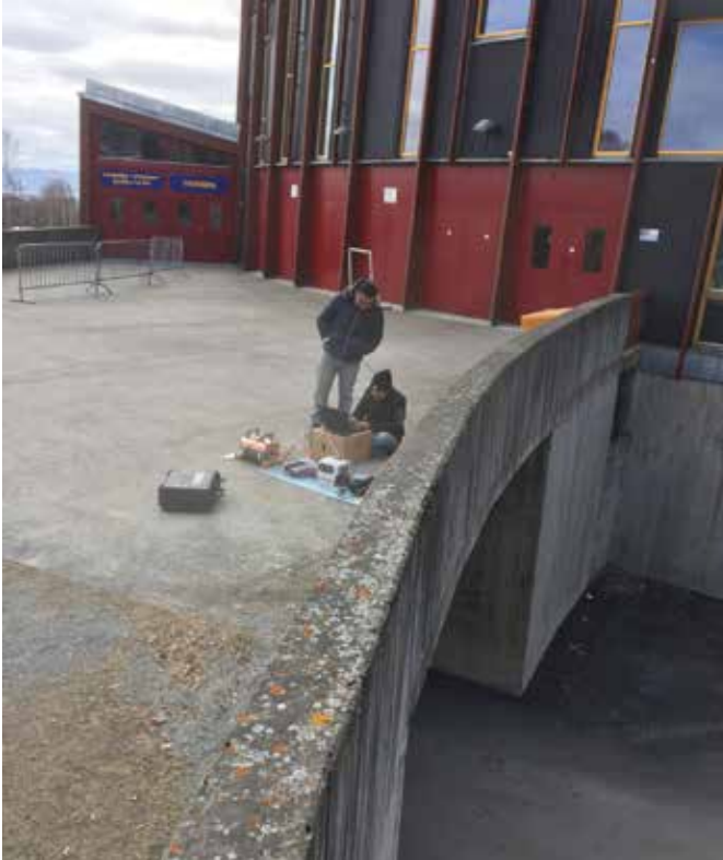
Test på 23 cm bro med opptil 24 mm steintilsats.
